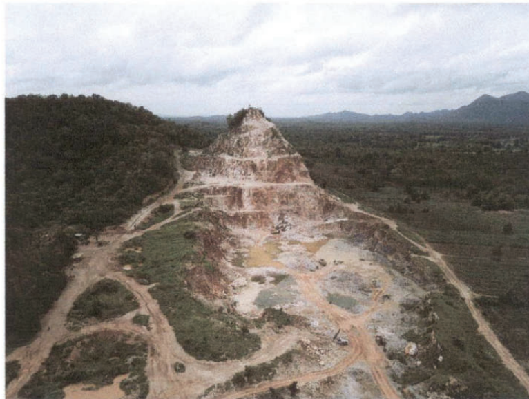
รูปที่ 1 แสดงสภาพพื้นที่หน้าเหมืองบริเวณด้านทิศตะวันตกของประทานบัตร เดินหน้าเหมืองไปทางทิศเหนือ มีการทำเหมืองเป็นแบบขั้นบันได
